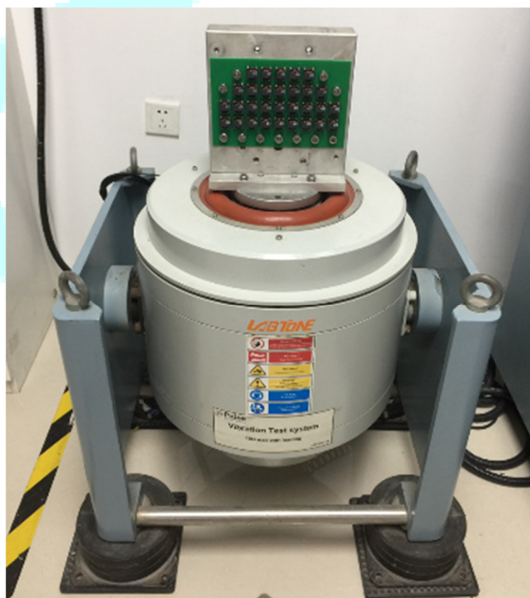
Fig. 6 Vibration Test (Z axis)
