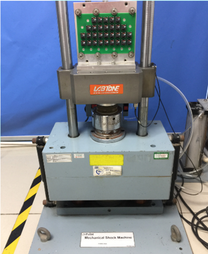
Fig. 6 Mechanical Shock Test (Z axis)
